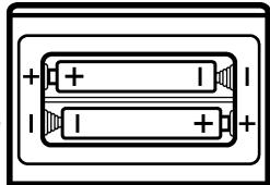
Lassen Sie keine leeren Batterien eingelegt, die Flüssigkeit kann auslaufen und die Fernbedienung beschädigen
