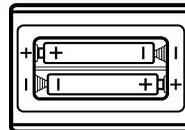
**BATTERIETEST:** Halten Sie die **5** Taste gedrückt und prüfen Sie, ob die LED kontinuierlich leuchtet, bis die Taste losgelassen wird. Wenn das Licht blinkt oder aus bleibt, sind die verwendeten Batterien nicht ausreichend geladen, ersetzen Sie sie.
