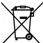
**CUIDADO:** As baterias não devem ser desmontadas, lançadas ao fogo ou liberadas no meio ambiente. O uso inadequado pode causar danos ao meio ambiente e à saúde. O símbolo de lixeira cruzada indica que as baterias devem ser descartadas de acordo com os regulamentos atuais; informe-se sobre a coleta de baterias e acumuladores usados em vigor no seu país.
