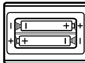
Si raccomanda di non lasciare inserite batterie esaurite, potrebbero rilasciare liquido e danneggiare il telecomando
