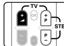
C) En el mando a distancia MELICONI, pulsar durante al menos 6 segundos ambas teclas [P +] y [◀ +] para la configuración de la parte de TV (o [P +] y [P -] para el DECODIFICADOR).
